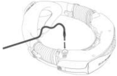
**WICHTIG: Um sicherzustellen, dass der Akku zu 100 % geladen ist, stellen Sie sicher, dass das Ladegerät an die Power Unit angeschlossen ist und die Leuchten der Akkuladeanzeige durchgehend grün leuchten (kein Blinken).**
