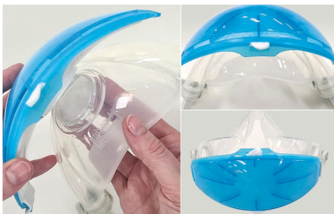
ÉTAPE 4 - Alignez le boîtier assemblé avec le filtre sur le capuchon d'expiration du masque de sorte que les événements du boîtier extérieur se trouvent au bas du masque. Emboîtez le boîtier dans l'embase de la valve d'expiration. REMARQUE : le capuchon de la valve d'expiration peut rester en place.
