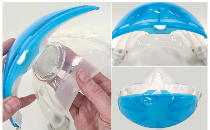
SCHRITT 4. Richten Sie das zusammengebaute Gehäuse mit dem Filter an der Ausatemkappe der Maske so aus, dass sich die Belüftungsöffnungen des äußeren Gehäuses an der Unterseite der Maske befinden. Klemmen Sie das Gehäuse auf den Sitz des Ausatemventils. HINWEIS: Die Kappe des Ausatemventils kann an Ort und Stelle bleiben.
