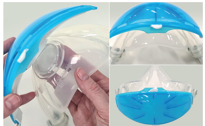
PASSAGGIO 4. Allineare la custodia assemblata con il filtro al cappuccio di espirazione della maschera in modo che le prese d'aria della custodia esterna si trovino nella parte inferiore della maschera. Fare clic sulla custodia sulla sede della valvola di espirazione. NOTA: il cappuccio della valvola di espirazione può rimanere in posizione.
