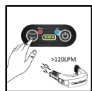
Test de débit - Les voyants lumineux de la batterie clignotent = ÉCHEC du test
