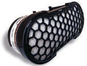
**Beschreibung** Der CleanSpace Combined Filter AX P2 TM2 (SL NR) Filter eignet sich zum Schutz vor Schwebstoffen (Staub, Nebel und Rauch) sowie bestimmten organischen Verbindungen mit niedrigem Siedepunkt ( $\leq 65^{\circ}\text{C}$ ) wie Methylbromid, Methanol, Aceton. Die Filtrationseffizienz ist größer als 99,95 % für Partikel von  $0,3 \mu\text{m}$  oder mehr. Der Filter PAF-0087 ist nur zum Einmalgebrauch bestimmt und muss nach jedem Gebrauch ersetzt werden.
