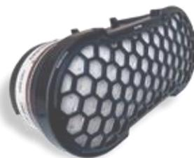
**Descrizione** Il filtro combinato CleanSpace AX P2 TM2 (SL NR) è adatto per la protezione contro il particolato aerodisperso (polvere, nebbie e fumi) e alcuni composti organici a basso punto di ebollizione (< 65°C) come bromuro di metile, metanolo, acetone. L'efficienza di filtrazione è superiore al 99,95% per particelle di 0,3 µm o superiori.
